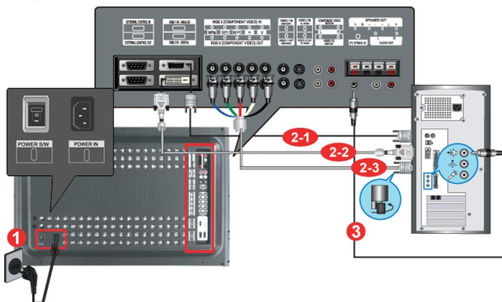
1. Collegare il cavo di alimentazione del monitor alla porta dell'alimentazione posta sul retro del monitor.
