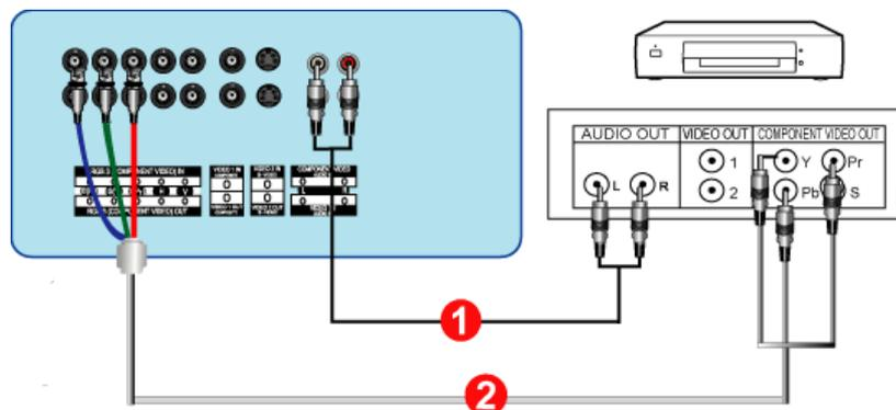
1. Collegare un set di cavi audio agli ingressi Audio sinistro **Terminale di collegamento audio Component (ingresso)** del monitor e alle uscite AUDIO OUT del lettore DVD.
