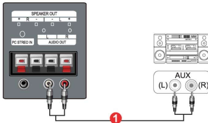
1. Collegare un set di cavi audio agli ingressi sinistro (L) e destro (R) AUX del Sistema audio e alle uscite sinistra (L) e destra (R) del monitor
