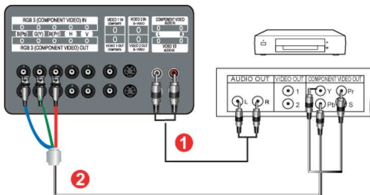
1. Collegare un set di cavi audio agli ingressi Audio sinistro **Terminale di collegamento audio Component (ingresso)** del monitor e alle uscite AUDIO OUT del lettore DVD.
