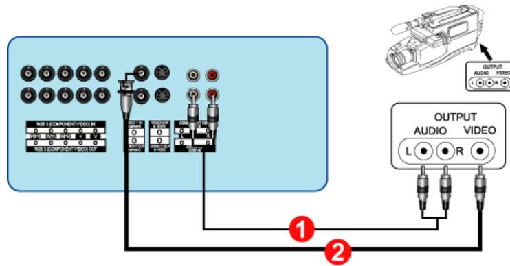
1. Individuare le uscite A/V della videocamera (solitamente situate lateralmente o dietro alla videocamera). Collegare un set di cavi audio alle uscite AUDIO OUTPUT della videocamera e agli ingressi **Terminale di collegamento audio S-Video, CVBS (ingresso)** del monitor.
