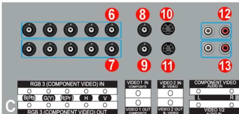
6. **Terminale di collegamento video del PC / Terminale di collegamento Component: Cavo BNC (ingresso)**
