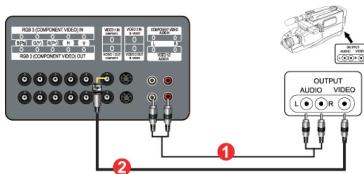
1. Individuare le uscite A/V della videocamera (solitamente situate lateralmente o dietro alla videocamera). Collegare un set di cavi audio alle uscite AUDIO OUTPUT della videocamera e agli ingressi **Terminale di collegamento audio S-Video, CVBS (ingresso)** del monitor.
