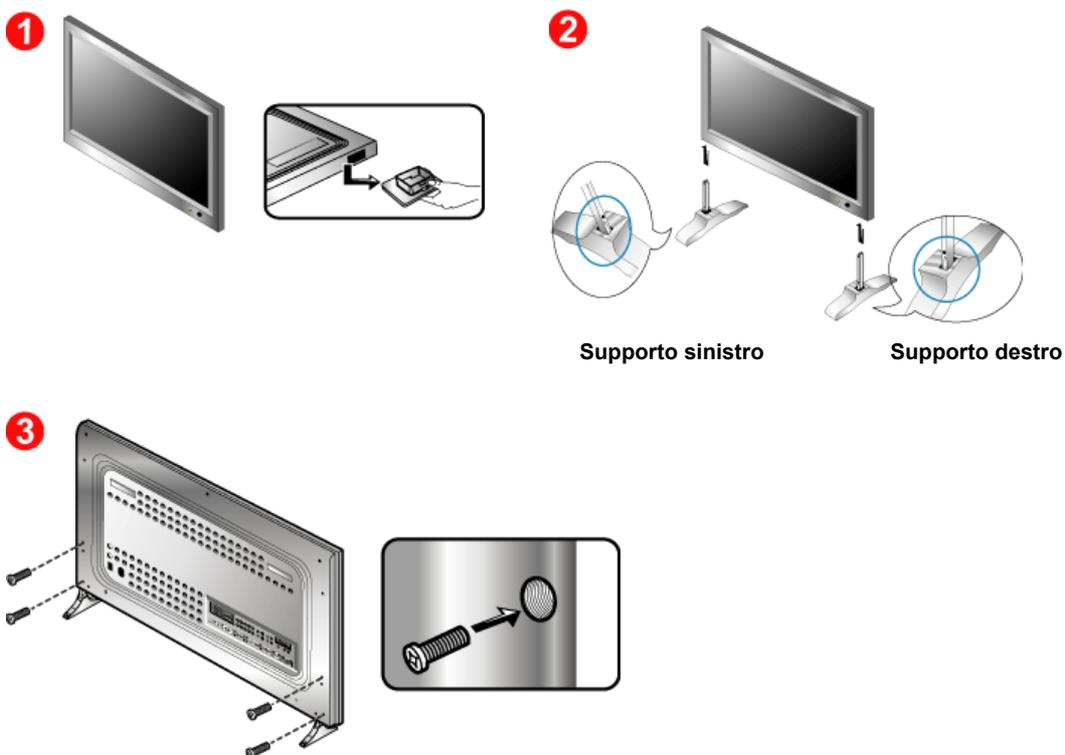
1. Un apposito tappo serve a proteggere il foro situato sotto al monitor, dove si inserisce il supporto. Accertarsi di rimuovere il tappo di protezione prima di inserire il Semi supporto o il Kit supporto (venduto separatamente) e tappare il foro utilizzando la [tappare la bocchetta](#) quando si fissa il kit di montaggio a muro.
