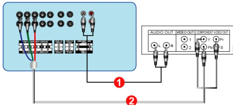
1. Collegare un set di cavi audio agli ingressi Audio sinistro **Terminale di collegamento audio Component (ingresso)** del monitor e alle uscite AUDIO OUT della Set Top Box.
