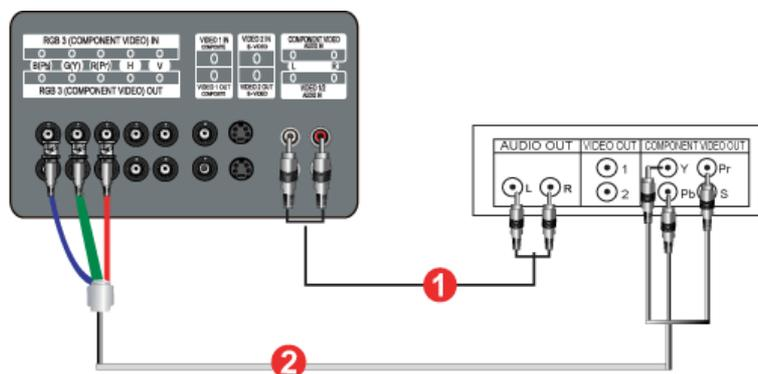
1. Collegare un set di cavi audio agli ingressi Audio sinistro **Terminale di collegamento audio Component (ingresso)** del monitor e alle uscite AUDIO OUT della Set Top Box.
