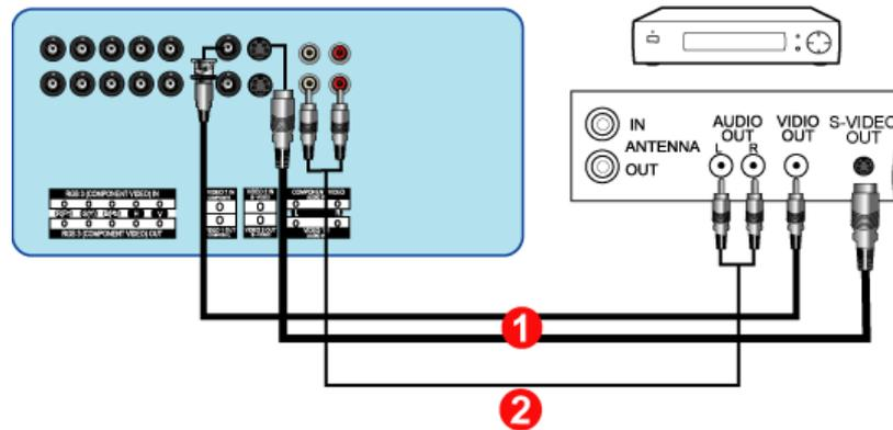
1. È possibile collegare ai terminali **Terminale di collegamento S-Video** o **Terminale di collegamento video CVBS** del monitor un dispositivo di videofrequenza quale un lettore videoregistratore o videocamera utilizzando il cavo S-VHS o il cavo BNC.
