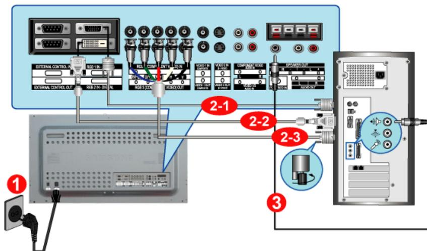
1. Collegare il cavo di alimentazione del monitor alla porta dell'alimentazione posta sul retro del monitor.
