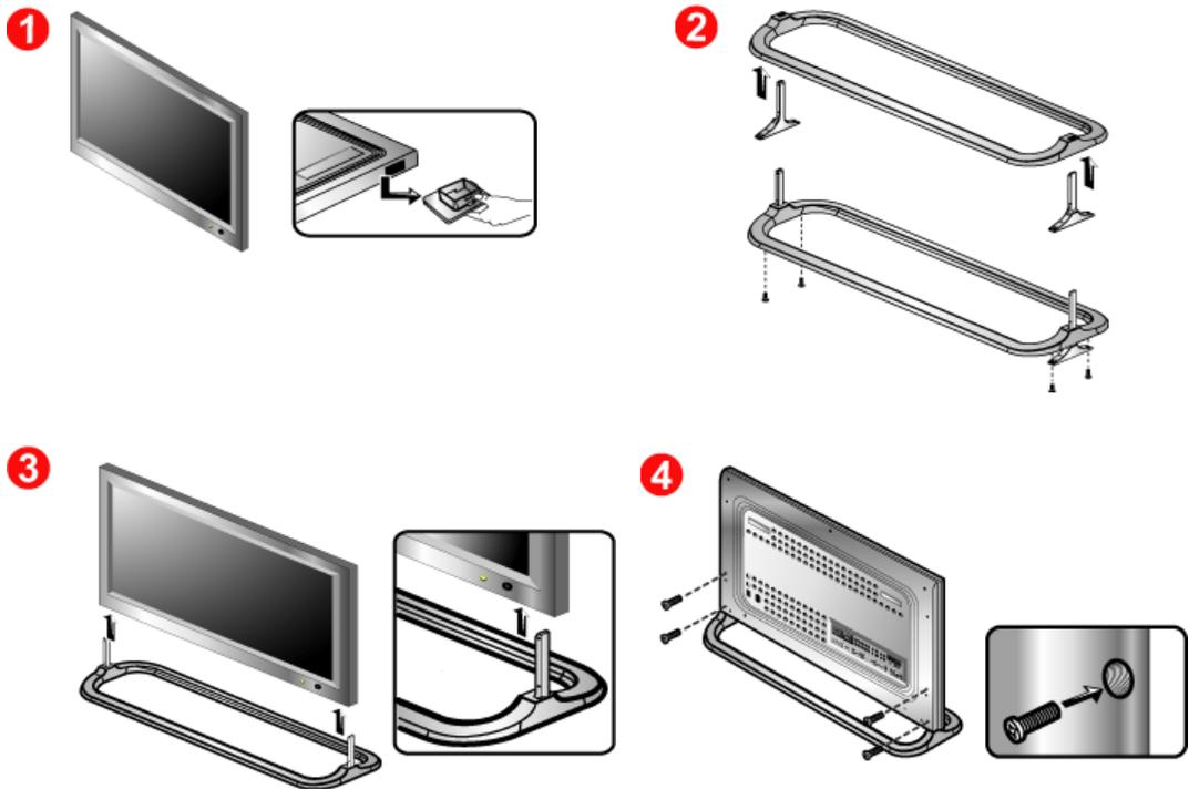
1. Un apposito tappo serve a proteggere il foro situato sotto al monitor, dove si inserisce il supporto. Accertarsi di rimuovere il tappo di protezione prima di inserire il Semi supporto o il Kit supporto (venduto separatamente) e tappare il foro utilizzando la [tappare la bocchetta](#) quando si fissa il kit di montaggio a muro.
