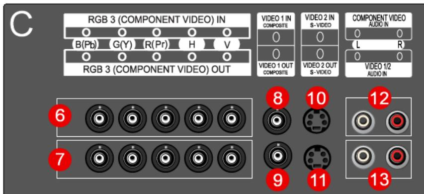
6. **Terminale di collegamento video del PC / Terminale di collegamento Component: Cavo BNC (ingresso)**
