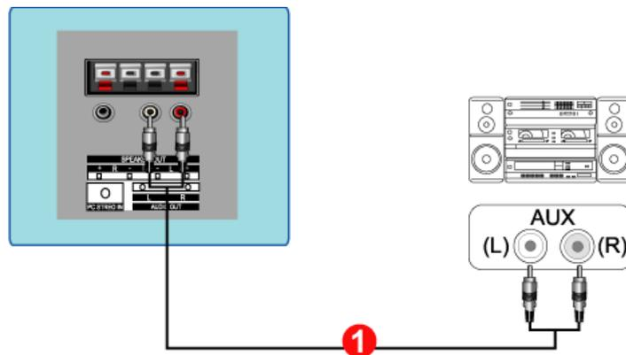
1. Collegare un set di cavi audio agli ingressi sinistro (L) e destro (R) AUX del Sistema audio e alle uscite sinistra (L) e destra (R) del monitor
