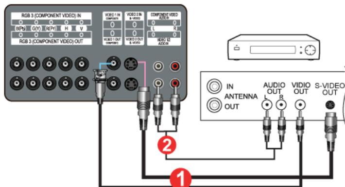
1. È possibile collegare ai terminali **Terminale di collegamento S-Video** o **Terminale di collegamento video CVBS** del monitor un dispositivo di videofrequenza quale un lettore videoregistratore o videocamera utilizzando il cavo S-VHS o il cavo BNC.
